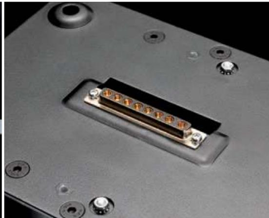
ren Fall bekommt das Exakt Engine ein eigenes Gehäuse mit zehn unabhängigen Ausgängen, ausreichend also zur Aktivierung von bis zu zweimal fünf Wegen.
